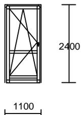
01 Sistema Telaio finestra 81mm      Misura telaio: 1100 x 2400
