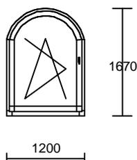
01 Sistema Telaio finestra 81mm      Misura telaio: 1200 x 1670
