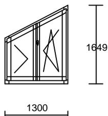
01 Sistema Telaio finestra 81mm      Misura telaio: 1300 x 1649
