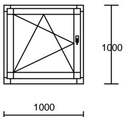
**01 Sistema Telaio finestra 81mm** Misura telaio: 1000 x 1000
