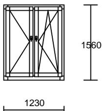
**01 Sistema Telaio finestra 81mm** Misura telaio: 1230 x 1560
