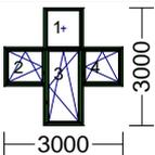
1 Stück  | <b>Einzeltypen-Konstruktion</b><br><b>1 tlg. Fixelement / 1-flg. Fensterelement / 1-flg. Balkontürelement / 1-flg. Fensterelement</b><br>Farbe Element tannengrün-tannengrün<br>Feld Standard Aufbau<br>1.1 Isolierglas (UG 1,1) 4/16/4<br>2.1 Isolierglas (UG 1,1) 4/16/4<br>3.1 Isolierglas (UG 1,1) 4/16/4<br>4.1 Isolierglas (UG 1,1) 4/16/4<br>Beschlag Fixfeld x Links / GS*/ Dorn 15 x Rechts / GS*/ Dorn 15<br>U-Wert 1.3<br><b>Maß</b> 3000 mm x 3000 mm |                   |               |
